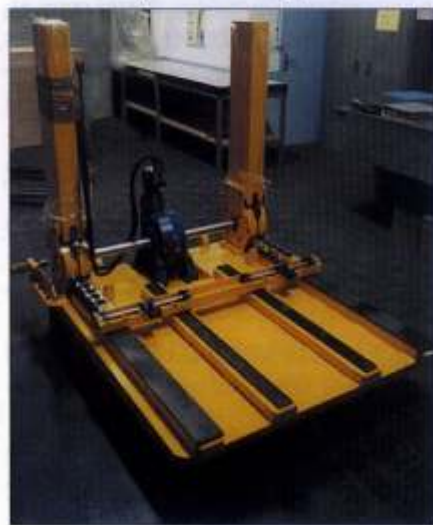
▲ L'accessoire TPCH est adaptable sur les fourches d'un chariot élévateur du commerce.
