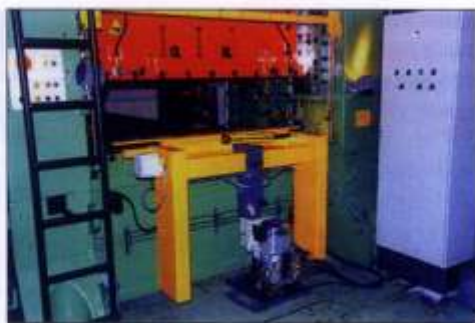
▲ Pousseur arrière. Monté sur une presse, il assure automatiquement l'entrée et la sortie de l'outil.
